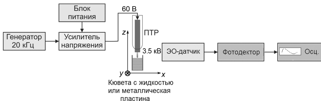
Рис. 6. Схема измерения напряженности электрического поля вблизи разряда пьезотрансформатора с использованием ЭО-датчика с эффектом Поккельса
