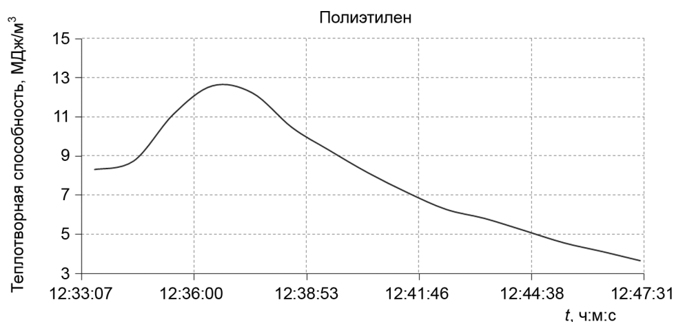
Рис. 3. Экспериментальные данные калорийности топливного газа при газификации 1 \text{ кг} полиэтилена
