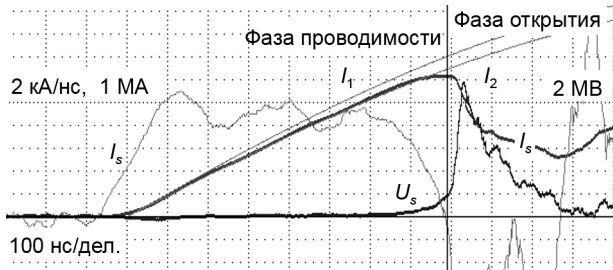
Рис. 3. Ток и напряжение на прерывателе
